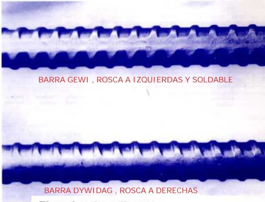
Fig. 1.2. La barra de la parte superior es GEWI Ø 32 mm., con rosca a izquierdas. La barra de la parte inferior es DYWIDAG Ø 32 mm., con rosca a derechas.
