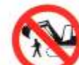
PROHIBIDO CIRCULAR O PERMANECER EN EL RADIO DE ACCIÓN DE LA ELEVADORA 213
