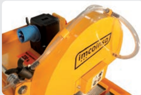
Eficaz y robusto sistema de refrigeración por agua Alarga la vida útil del disco.
